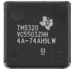
DSP utilizado en la unidad MDR-NC500D
